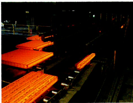
連続鑄造設備
